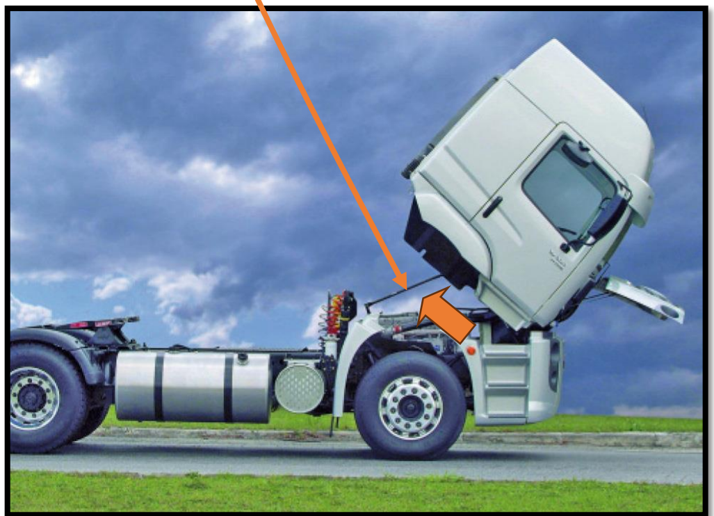
Exemplo de basculamento de cabine de caminhões realizado pelo cilindro hidráulico.
